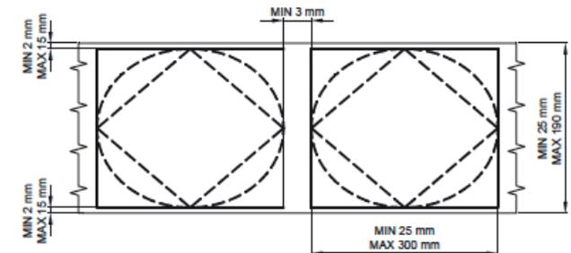
Vermaßung für Vorder- & Rückenetiketten sowie der Stand bei getrennten Rollen für Vorder- und Rückenetikett.
