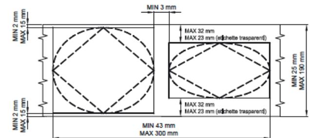
Vermaßung für Vorder- & Rückenetiketten sowie der Stand bei Vorder- und Rückenetikett auf einer Rolle.
